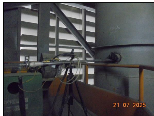
ภาพที่ 3.8 การตรวจวัดคุณภาพอากาศจาก ปล่องหม้ออบซีเมนต์ 9
